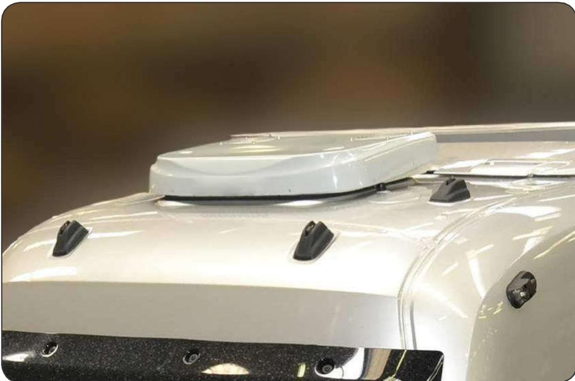
Fixer le climatiseur à l'aide des brides **B** : introduire les extrémités des brides sous le revêtement de telle sorte qu'elles fassent prise sur les parties métalliques ; introduire les vis **CC** avec les rondelles **DD** et les écrous **EE** et les visser dans les embouts filetés situés sous le climatiseur. Mettre en tension puis serrer les écrous **EE** contre les brides **B**.
