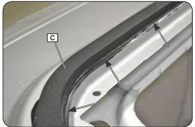
Introduire le câblage d'alimentation dans l'espace situé entre le toit et le revêtement sur le pare-brise puis le diriger vers les points d'alimentation présent à l'avant du véhicule. **NB** : dans le cas où il serait nécessaire de prolonger le câblage électrique, utiliser un câble d'alimentation de section supérieure à celle du câble fourni et le protéger au moyen d'un fusible.
